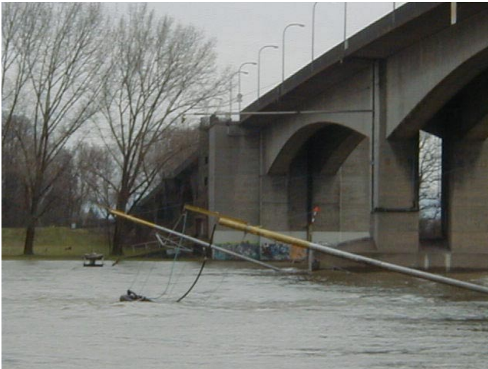
Bild 6.17: Vorrichtungen zur Probenahme aus der Flussmitte im Rhein bei Worms
